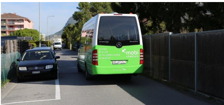
Figure 72 : Rue en zone 30 sans trottoir mais avec stationnement longitudinal
