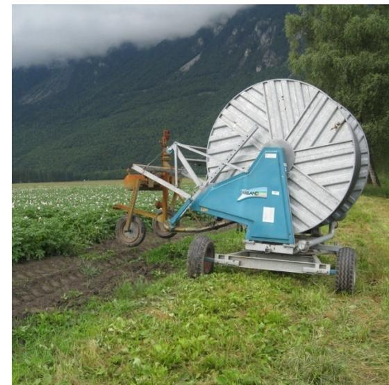
Irrigation par aspersion du type bobine.
