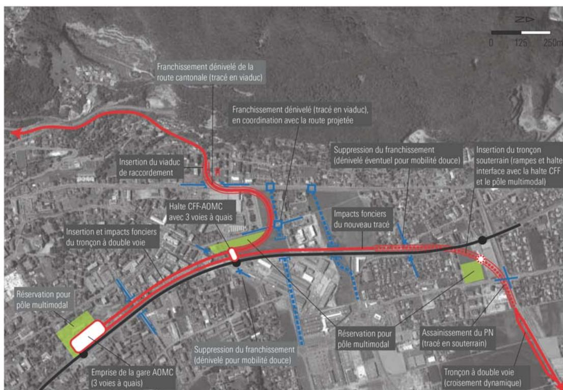
Figure 12 : Projet de déplacement du tracé AOMC entre Collombey et Monthey
